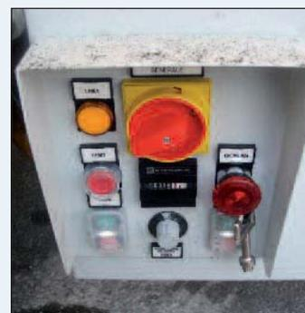
Figura 14: Os comandos do quadro elétrico são agrupados e protegidos dos respingos de água, e girando a manivela central é possível regular a vazão do reboco
