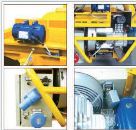
Figura 12: O vibrador garante uma peneiragem rápida e eficaz, o compressor uma projeção uniforme e o quadro elétrico é de fácil desmontagem
