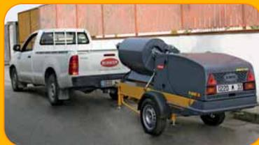
O eixo Alko de 1000 kg com pneus de 165 garante uma estabilidade excepcional para um reboque seguro mesmo em velocidades elevadas.
