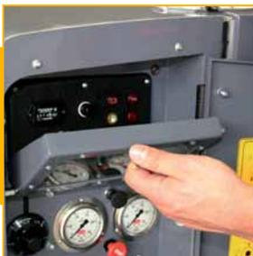
A capota é revestida internamente de material anti-ruído e é caracterizada por uma ampla e fácil abertura.
