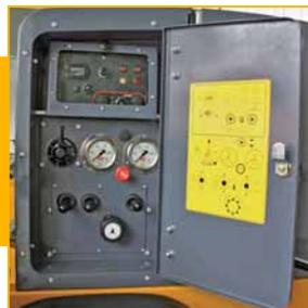
O quadro de comandos permite o controle de todas as funções exibindo o estado de funcionamento. O quadro elétrico é ainda protegido por uma tela em plexiglass de alta resistência.
