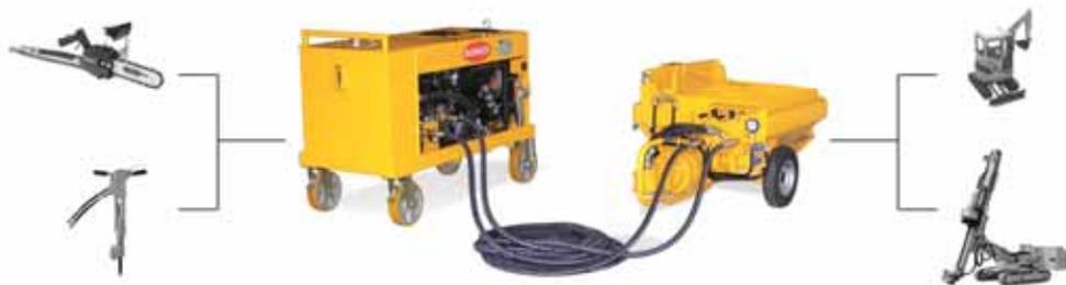
Dalla Bunker la pompa per calcestruzzo a cavità elicoidale più piccola al mondo a totale funzionamento oleodinamico. Con regolazione progressiva della portata da zero a 15 m<sup>3</sup>/h e della pressione fino a 25 bar. Pompa e centralina sono separate per ridurre peso e dimensioni e consentire l'azionamento anche dalla presa idraulica di un'altra macchina da cantiere e di utilizzare la centralina per azionare anche degli utensili idraulici. Un bel vantaggio!...
