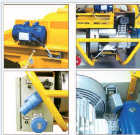
Figura 12 - Il vibratore assicura una vagliatura rapida ed efficace, il compressore una spruzzatura uniforme e il quadro elettrico è di facile smontaggio
