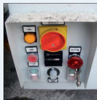
Figura 14 - I comandi del quadro elettrico sono raggruppati e protetti dagli spruzzi d'acqua, e ruotando la manopola centrale è possibile regolare la portata dell'intonaco
