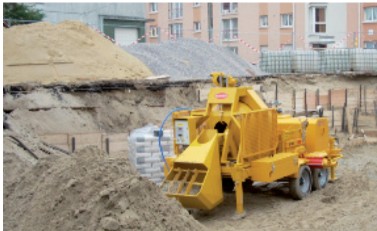
L'unità mobile di pompaggio B100xp è a totale funzionamento oleodinamico, con regolazione della portata e della pressione, realizzata dalla Bunker per produrre direttamente in cantiere il calcestruzzo da pompare o spruzzare.
