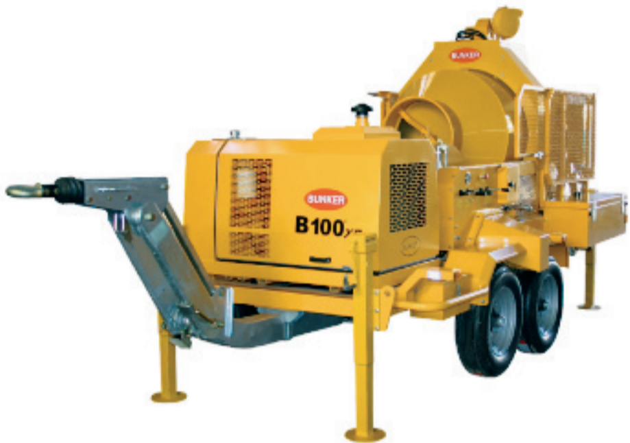
L'unità mobile di pompaggio B100xp è a totale funzionamento oleodinamico, con regolazione della portata e della pressione, realizzata dalla Bunker per produrre direttamente in cantiere il calcestruzzo da pompare o spruzzare.
