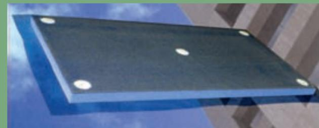
**ECAP DI EDILTECO** è un pannello isolante prefinito destinato alla realizzazione di isolamenti esterni a cappotto e interni di pareti e soffitti. Sia nella versione con isolante in Eps (disponibile in spessori da 20 a 120 mm, formato 600x1200 mm), sia in quella con isolante in fibra di legno da 230 kg/m3 (disponibile in spessori da 60 a 100 mm, formato 1390x790 mm), il pannello viene fornito già rasato, su rete in
