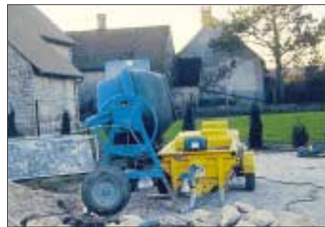
S8 SMART con betoniera
