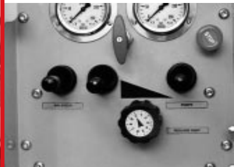
Due pratiche leve azionano il sollevamento e la rotazione del mescolatore
