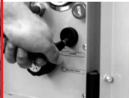
Con semplicità è possibile invertire la rotazione della pompa a vite permettendo lo svuotamento delle tubazioni
