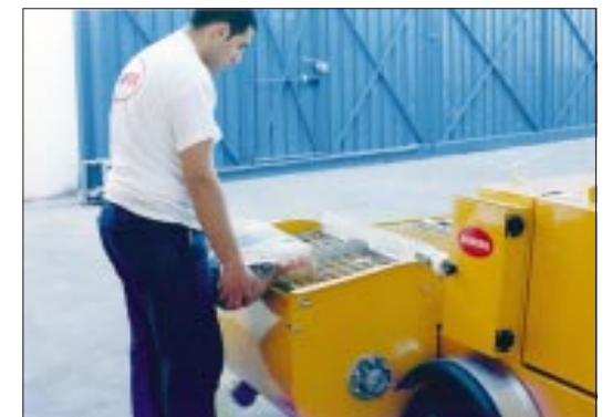
Minimo sforzo di carico grazie alla bassa altezza del mescolatore a ribaltamento idraulico
