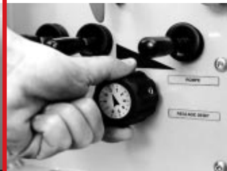
La regolazione progressiva della portata garantisce una intonacatura perfetta, evitando spreco di materiale
