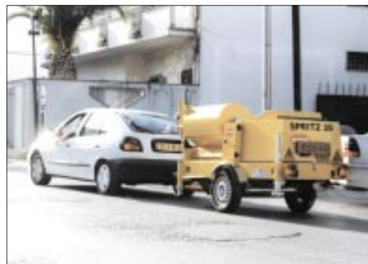
Il nuovo assale ALKO garantisce una eccezionale stabilità, per un traino sicuro anche con normali autovetture
