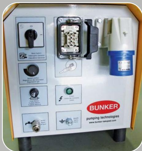
Quadro elettrico con innesto rapido tubo acqua e regolazione della velocità di rotazione.
