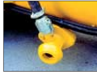
Sortie cuve avec raccord Perrot
