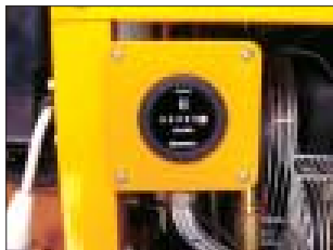
Le compteur d'heures contribue à programmer le travail et l'entretien.
