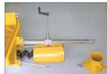
Zum Zubehör der B100 gehört das innovative Werkzeug, mit dem der Austausch des abgenutzten Stators auf einfache und sichere Weise ermöglicht wird.
