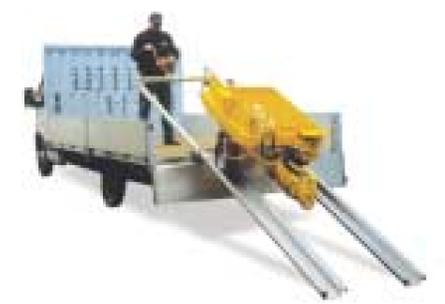
Um den Einsatz der B100 noch schneller und praktischer zu gestalten, hat die Firma Bunker die Laderampe Fast 600 entwickelt, die das Auf- und Abladen der Pumpe und des Steuergehäuses auf besonders innovative Weise ermöglicht.
