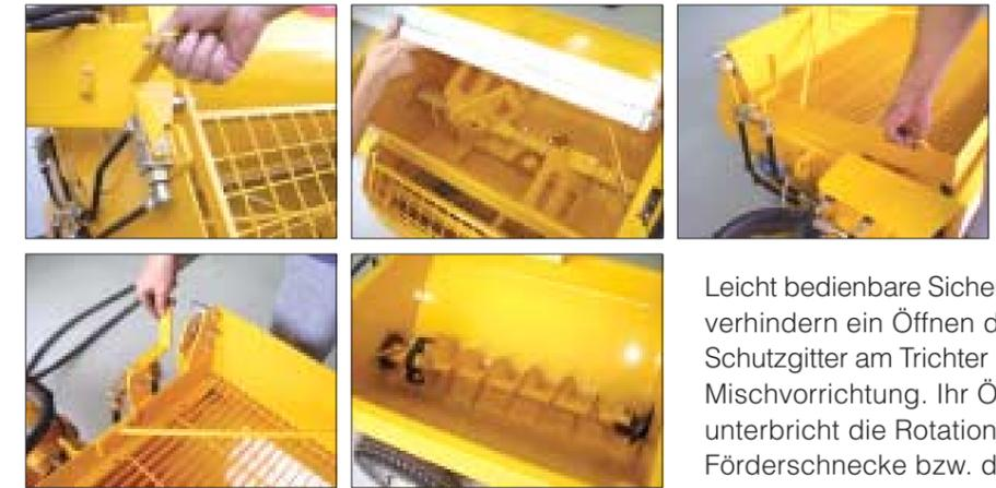
Leicht bedienbare Sicherheitshebel verhindern ein Öffnen der Schutzgitter am Trichter und an der Mischvorrichtung. Ihr Öffnen unterbricht die Rotation der Förderschnecke bzw. der Schaufeln der Mischer.
