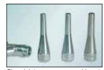
Bicos injetores para preenchimento de fissuras
