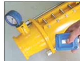
La macchina è dotata di una comoda pulsantiera a bassa tensione con cavo elettrico.
