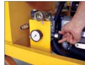
La regolazione progressiva della portata del pompaggio garantisce iniezioni e spruzzature accurate.
