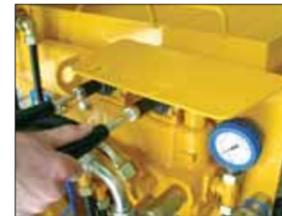
Con semplicità è possibile azionare ed invertire la rotazione della pompa a vite permettendo lo svuotamento delle tubazioni in caso di intasamenti.
