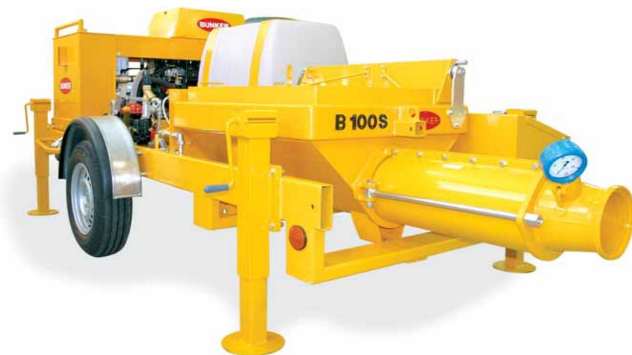
*Caratteristica peculiare* della B100S è che tutti i componenti dell'impianto (la centralina oleodinamica, la pompa per la spruzzatura, il serbatoio e la pompa per accelerante di presa) sono sistemati su un'unica slitta carrellata facilmente trainabile. Soluzione che agevola il lavoro e aumenta la produttività.
