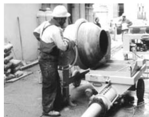
Le ridotte dimensioni facilitano il posizionamento sotto le unità di carico: betoniere, molazze, ecc.
