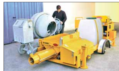
alimentée par une bétonneuse
