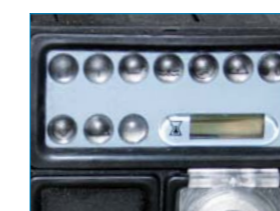
Des voyants lumineux permettent un contrôle très aisé des fonctions de la machine, et le compteur d'heures contribue à programmer le travail et l'entretien.
