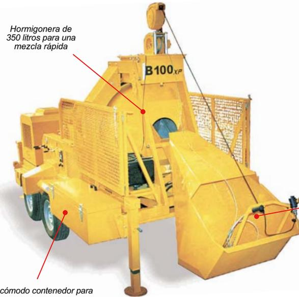
Hormigonera de 350 litros para una mezcla rápida
