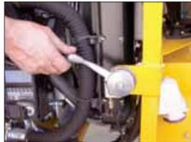
La velocidad del motor Diesel puede ser regulada gracias a una práctica palanca.
