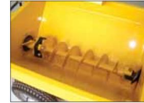
Cierres mecánicos fáciles de utilización impiden la apertura de las rejillas de la tolva y del mezclador. Su apertura para la rotación del tornillo o de las palas de mezclado.
